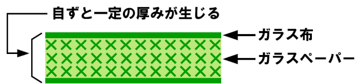
▲CEM-3 材の材料構成
