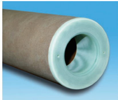
▲紙フェノール積層管の巻き芯 チャックがあたる部分はガラスエポキシのフランジで補強されています。
