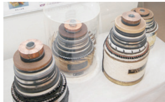
▲電力ケーブルのカットモデル
