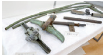
▲黒部川水系の発電所群から日本で初めて275kV送電が始まったころの送電金具。
