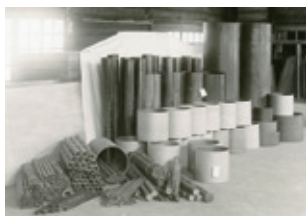
▲熱硬化性樹脂積層管 (1935年撮影) もうすぐ100年のロングセラーです。
