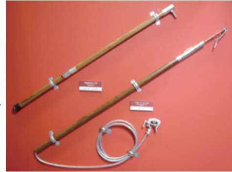
▲断路器操作用フック棒(上)とアースフック棒
