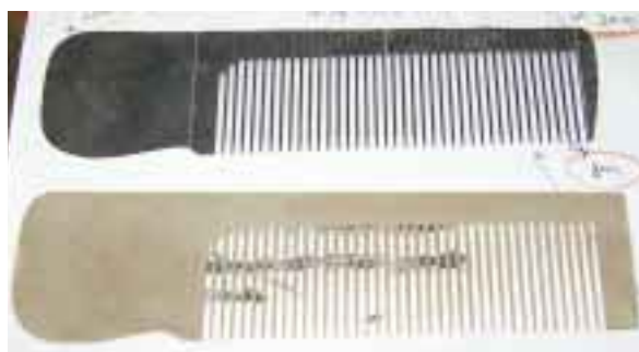
究極のカスタムオーダー 上段:櫛のコピーが注文書。下段:それをもとに加工中のもの。 布フェノール指定で注文数は1本。
