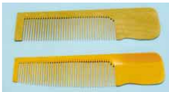
材料による違い 上段:布フェノール 下段:紙フェノール 布入りは強度に優れます
