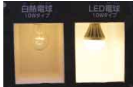
白熱電球とLED電球の明るさ比較 (消費電力は同じ)
