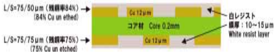
図2 .試験パターン Fig.2 Test piece image
