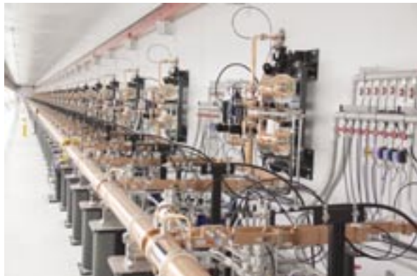
直線400メートルのSACLAの加速管。 Cバンドマイクロ波で電子を光の速さ近くまで加速します。 写真ご提供:理化学研究所様
