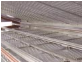
リフロー装置の内部。上下の丸孔から熱風が出る。
