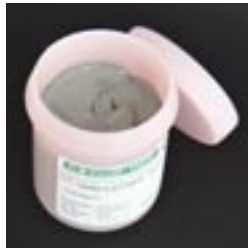
はんだとフラックスが一体となった「ソルダーペースト」
