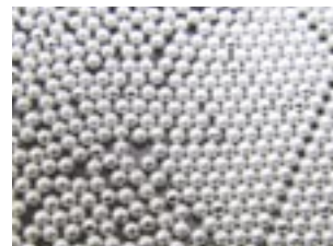
マイクロはんだボール 直径20μm(2/100mm)のものも出現しております
