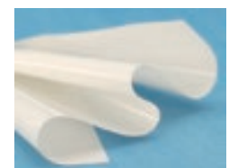
▲熱硬化後の樹脂層 非常にしなやかでアルミ板の寸法変化を吸収します
