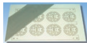
▲アルミベース基板材料の加工品(デモ品) 説明のために絶縁層の一部を剥いだもの ご協力: テクノ電子株式会社様
