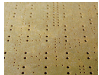
▲使用済みバックアップ・ボード。高機能活性炭へとアップグレード。
