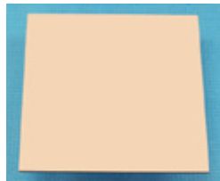
▲CCLの外観 全面銅箔張りです。 このあとさまざまな加工を経てプリント配線板(PWB)になります。
