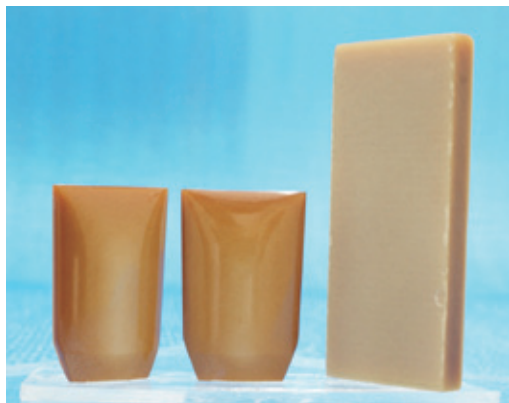
▲CNF成型体(右)とこれを切削加工した箏爪
