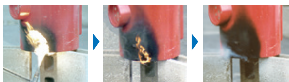
①炎を近づけても容易に着火せず ②かりに着火しても、炎を外すと ③すぐに自己消火
