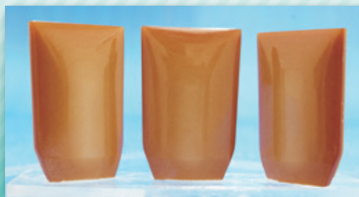
▲新たに開発したCNF成型体を切削加工して得られた箏爪「玄武」 ご提供：株式会社三島屋楽器店(新潟県長岡市)様
