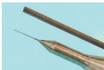
▲直径0.13mmのドリル錐 (0.5mmシャープ芯との比較)
