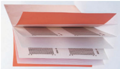
▲内層回路入り多層銅張積層板のイメージ (6層板)
