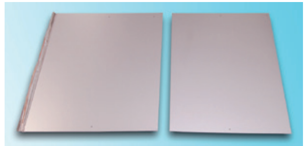
▲外形加工前の多層板(左)と外形加工後の多層板 銅板のような外観ですが、内部には何層かに分けて、お客様ごとに異なる回路が敷いてあります。数値制御によるタテヨコの位置決めで、さまざまな加工が施されますので、外形加工の品質は非常に重要です。
