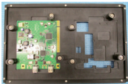
▲フローパレットにセットされたPWB
