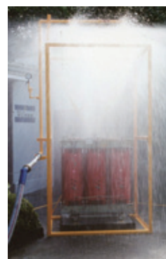
▲スプリンクラー試験 (水消火を想定)
