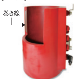
▲巻き線をガラス繊維強化エポキシ樹脂で絶縁した頑強なコイル(カットモデル)
