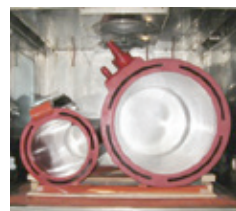
▲冷熱サイクル試験 (耐クラック性の試験)
