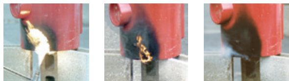
①炎を近づけても → ②かりに着火しても、 → ③すぐに自己消火容易に着火せず 炎を外すと
