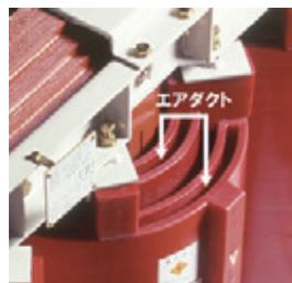
▲コイルに設けたエアダクト。電動ファンがなくても自然な空気の対流でコイルを冷却します。
