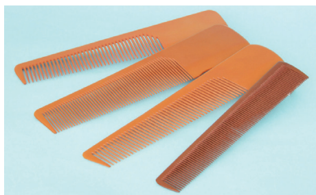
▲「理容コーム」(フェノール樹脂積層板の加工品) 手前は布基材、奥の3枚は紙基材の積層板を切削加工したもの 提供:平尾櫛製作所様
