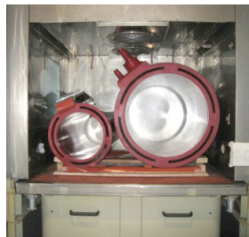
▲耐クラック試験 (コイルを冷熱試験機にセット)
