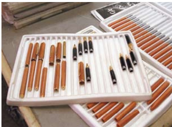
▲組み立て前のパーツ。ひとつひとつが職人さんによる削り出しで、まさに工芸品です。
