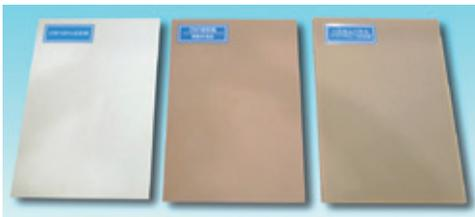
▲左から、①CNF100%の成形板。②樹脂で吸水対策したCNF成形板。③②の薄板でCNFハニカムをサンドイッチしたパネル。
