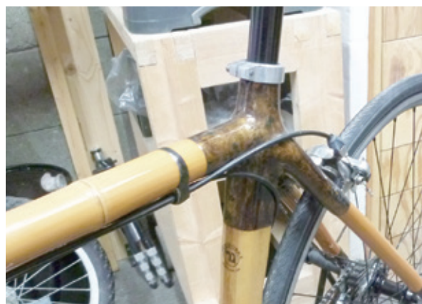
▲竹フレームのジョイント部
