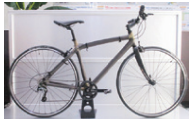
▲セルロースナノファイバー100%のパイプをフレームにしたCNF Bike。
