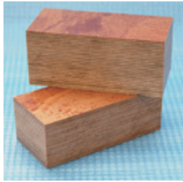
▲絶縁強化木「ウッドライト」 木材を「かつら剥き」にした薄い板(単板)にフェノール樹脂を 含浸して高温・高圧でプレスします。
