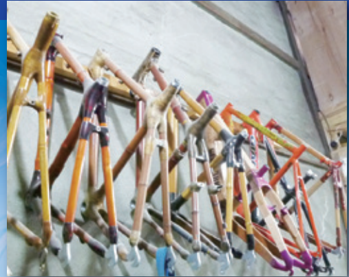
▲体に優しい竹製の自転車フレーム
