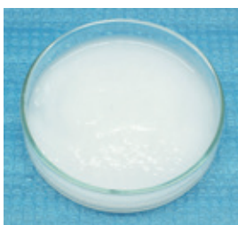
▲CNF。90%以上の水を含む「スラリー」の状態を提供されます。ここから水を排してCNFのみのパイプに成形するのは、けっこう大変です。
