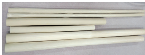
▲セルロースナノファイバー100パーセントのパイプ(自然色) ハンドメイドの試作品ですが、世界初の材料であると推察しています。
