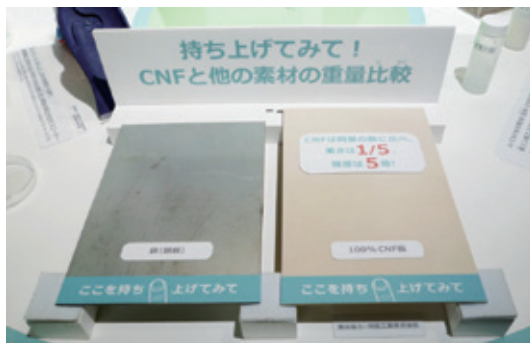
▲銅板(左)とセルロースナノファイバー100%板の重量比較ができます。
