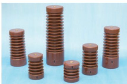
▲リショーキャスト エポキシ樹脂検電がいし。得意とする注型技術で配電盤向けにセラミックコンデンサをエポキシモールドしたものです。
