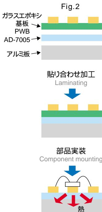
を介してアルミ板などに貼り合わせることで、簡易的に熱対策基板を製作することができます。
