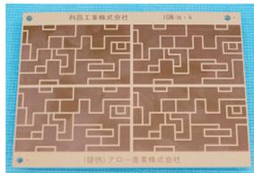
▲AC-7210Nを用いた電力変換用半導体搭載基板(デモ品) ご協力:アロー産業(株)様
