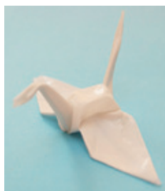
▲鶴が折れるほどの柔軟性を備えています(硬化前)
