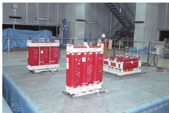
▲加振試験のようす。兵庫県南部地震の揺れを再現しました。右の変圧器は倒れているのではなく、耐震性能に優れる「横置きタイプ」です。当社ホームページで、この試験の動画をご覧いただけます。
