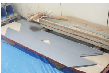
▲最小部品である電磁銅板の状態で搬入
