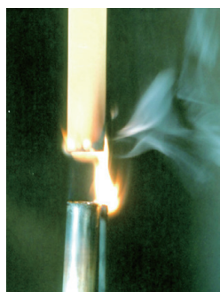
▲UL94に基づくプラスチック材料の20mm炎垂直燃焼試験のイメージ
