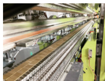
▲挿入光源の内部。上下に多くの永久磁石が見えます。稼働時にはフタが閉じられ真空状態にして電子ビームが投入されます。
