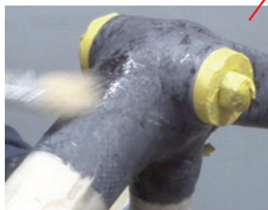
▲ボトムブラケットとCNFパイプの接合 カーボンファイバーにエポキシ樹脂を含浸させたテープで固定。熱硬化させラグのように仕上げます。
