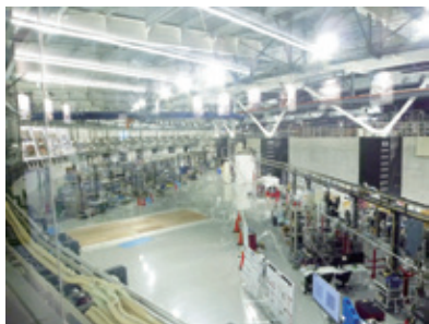
▲ビームライン。写真に見えるのは左右の2本のみですが、用途に応じてカスタマイズしたものが全部で10本あり、同時稼働が可能です。蓄積リングと挿入光源は右側に見える壁の向こう側です。
