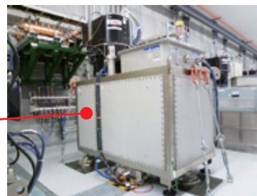
▲線型加速器の電源装置(クライストロン)
