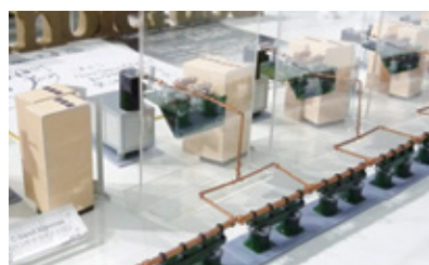
▲クライストロンと加速管の位置関係がわかる模型。
